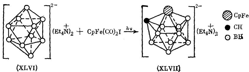
Комплекс (XLVII) был получен также при кипячении раствора  $K_2^+ B_{10}H_{10}^{2-}$  и  $CpFe(CO)_2I$  в 1,2-диметоксиэтане.
