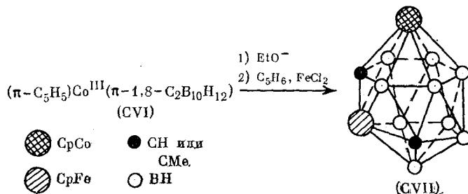
Комплекс (CVII) при действии  $\text{NaBH}_4$  восстанавливается до диамагнитного моноаниона  $[\text{4-CpCo-5-CpFe}^{\text{II}}-1,8-\text{C}_2\text{B}_9\text{H}_{11}]^-$ .
