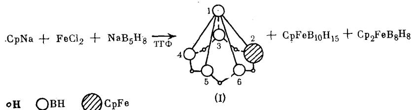
Строение  $\text{Cp}_2\text{FeB}_8\text{H}_8$  не установлено, а структура  $\text{CpFeB}_{10}\text{H}_{15}$  будет обсуждена ниже. Комплексу (I) на основании спектров ЯМР  $^1\text{H}$  и  $^{11}\text{B}$  приписано пентагонально-пирамидальное строение. При нагревании в дейтеротолуоле комплекс (I) перегруппировывается в изомерный ферраборан (II), являющийся структурным аналогом ферроцена:
