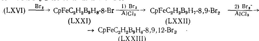
Строение бромпроизводных (LXXI) — (LXXIII) доказано спектроскопией ЯМР  $^{11}\text{B}$ , а также встречным синтезом из бромпроизводных (LXXIV) и (LXXV), имеющих Br-атомы в известных положениях 9 и 9, 12:
