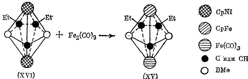
Комплекс (XV) получается в смеси с другими металлокарборанами, причем наибольший выход его получен при проведении реакции в кипящем мезитилене.
